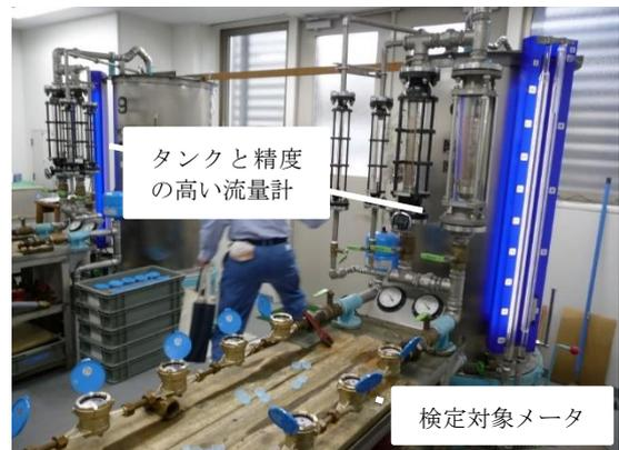
図 2.2 メータ精度調査のテストベンチ
