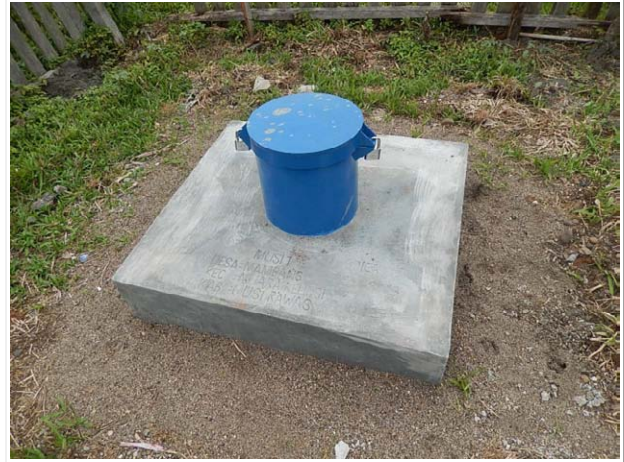
地下水位観測井 (Mambang)
