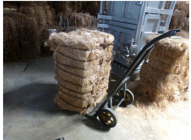
125Kg のアバカ梱包と梱包用機械 (後方) (アルバイ州タバコ市 ONE INFINITY 社)
