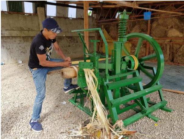
パイロットテスト (古川モデルのスピンドルマシン) (カタンドアネス州バト地区シピ PLDC マニラ麻集荷場)
