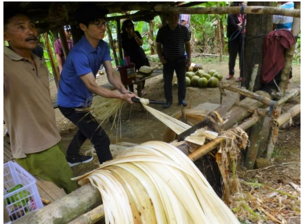
調査団員によるアバカトクシーの手挽き (カタンドアネス州サンミゲル)
