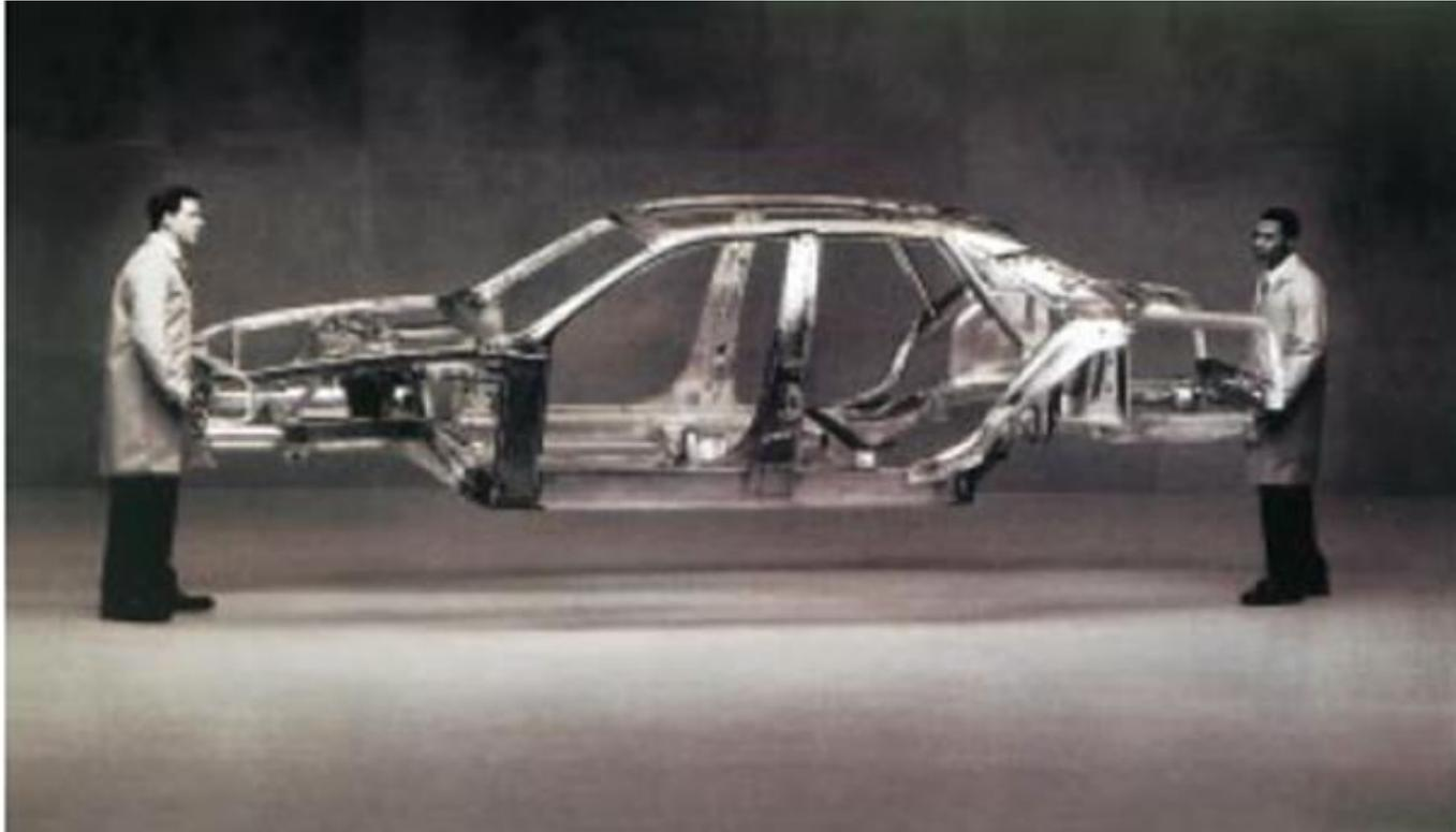
*Projeto Audi, utiliza alumínio em ligas de alta resistência, na construção do chassi e outros componentes.*
