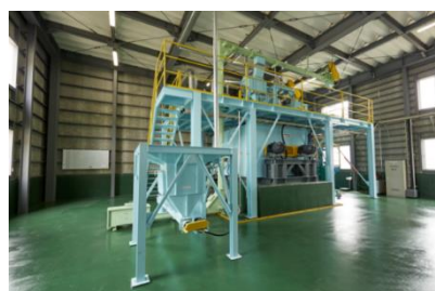
写真：水銀安定化設備 a
