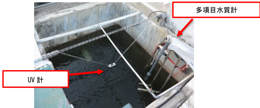
図9 多項目水質計及びUV計による水質測定
