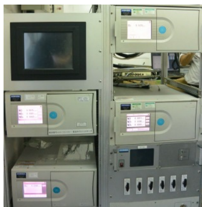
O 3 計及び NO x 計による並行測定(2018.10.25)
