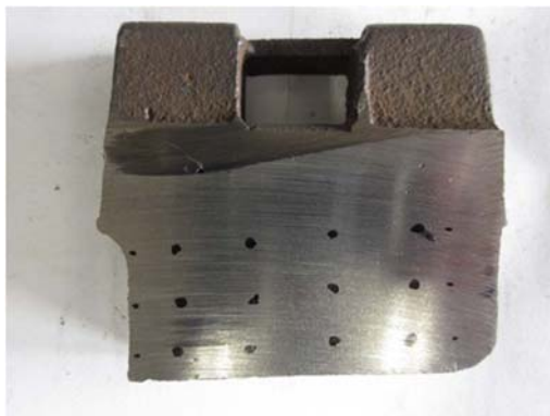
図 2-2 マッカサン工場製硬さ測定位置と測定結果(HBW10/3000)
