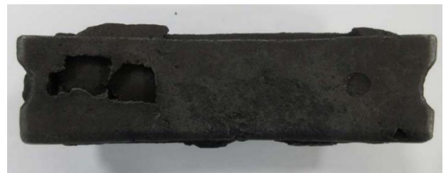
写真 2-25 マッカサン工場製鋳鉄制輪子外観
