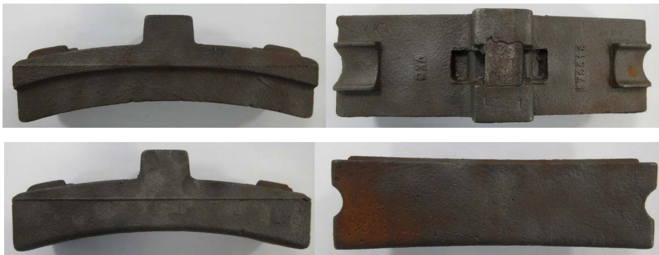
写真 2-26 VKC 製（入札購入品）鋳鉄制輪子外観
