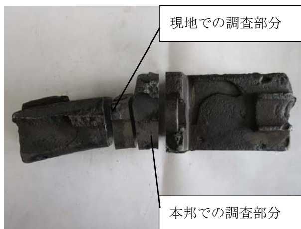
写真 2-27 マッカサン工場製材質調査位置
