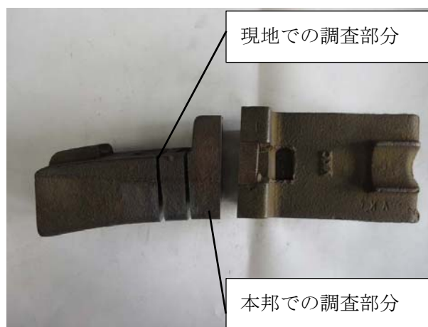
写真 2-28 VKC 製摺動面表層材質調査位置
