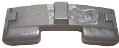
鉄道用制輪子（鋳鉄制輪子）
