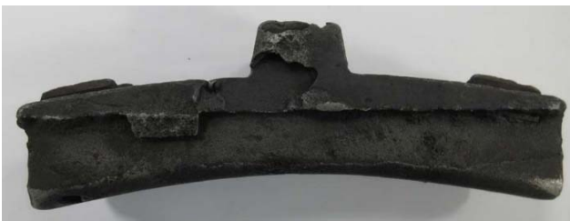
写真 2-25 マッカサン工場製鋳鉄制輪子外観
