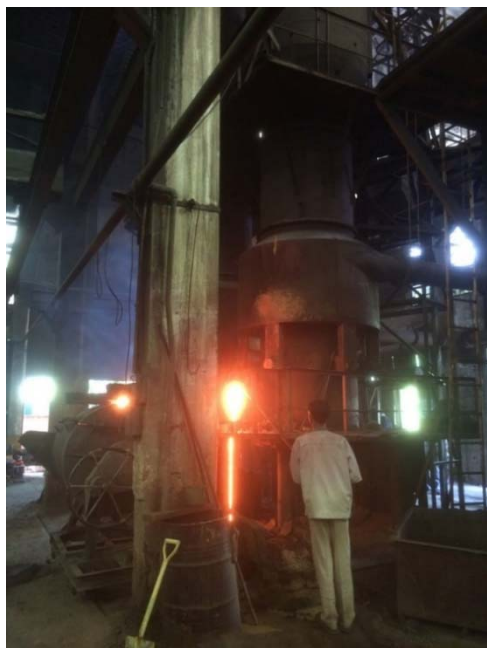
写真 2-5 キュポラの稼働状況
