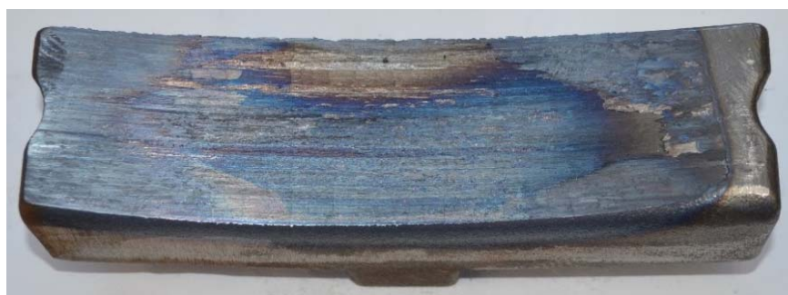
写真 2-35 最高速度からの試験後制輪子摺動面
