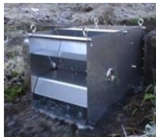
写真 小水力発電機
