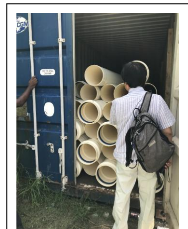
写真 2 マキラ州に導入する水力発電用のパイプ
