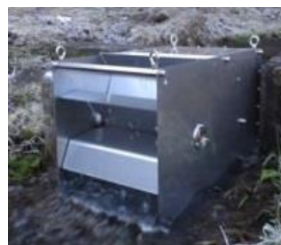
写真1 小水力発電機
