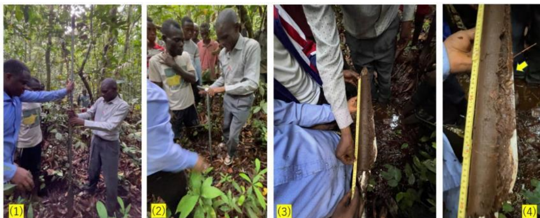
図 3. 2. 3. 7 Inongo 地区の調査地点 (No. 3) における泥炭ボーリングの状況
