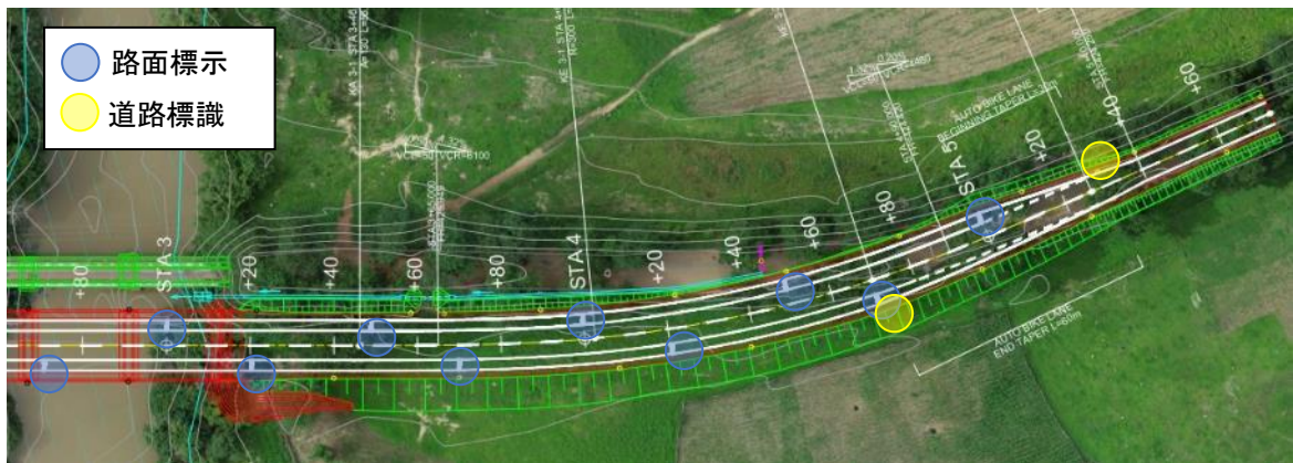
図 3-2-23 オートバイレーンの路面標示、標識の設置位置（東岸）
