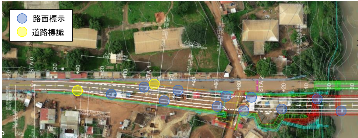
図 3-2-22 オートバイレーンの路面標示、標識の設置位置（西岸）
