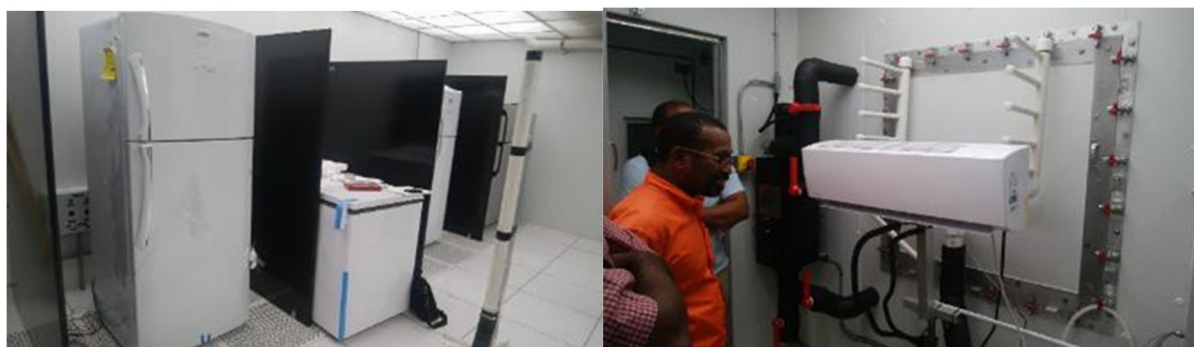
図 3-13 BSJ 内の効率測定用環境試験室(左: 冷蔵庫、右: ルームエアコン)
