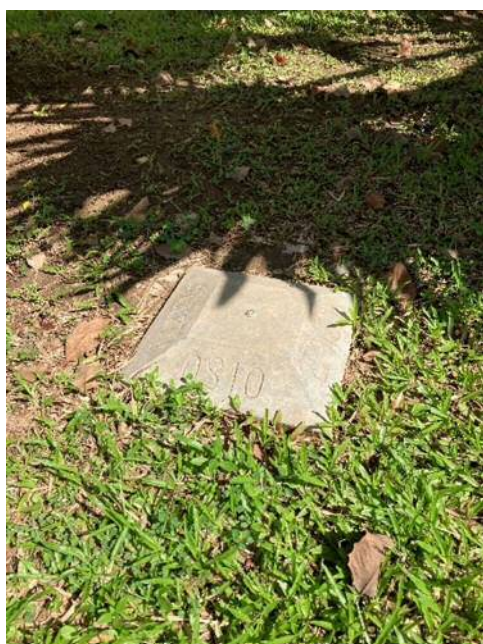
写真3 CORS 周辺に点在する旧座標系による 既設標石
