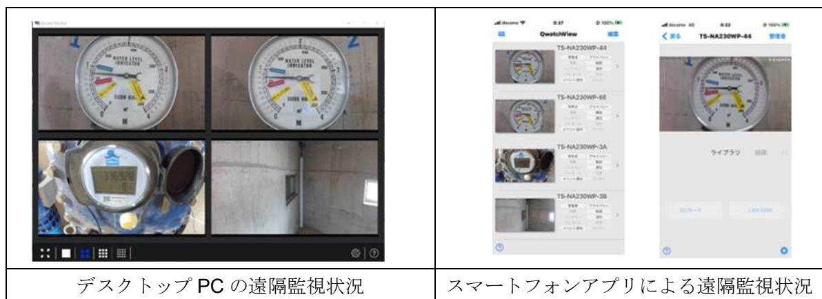
写真 4 Parliament 配水池の水位・配水量の遠隔リアルタイム監視
