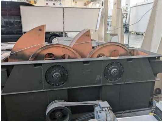
状況診断する際に屋上に設置して使用する 加振機（トリノ工科大学タシケント校）
