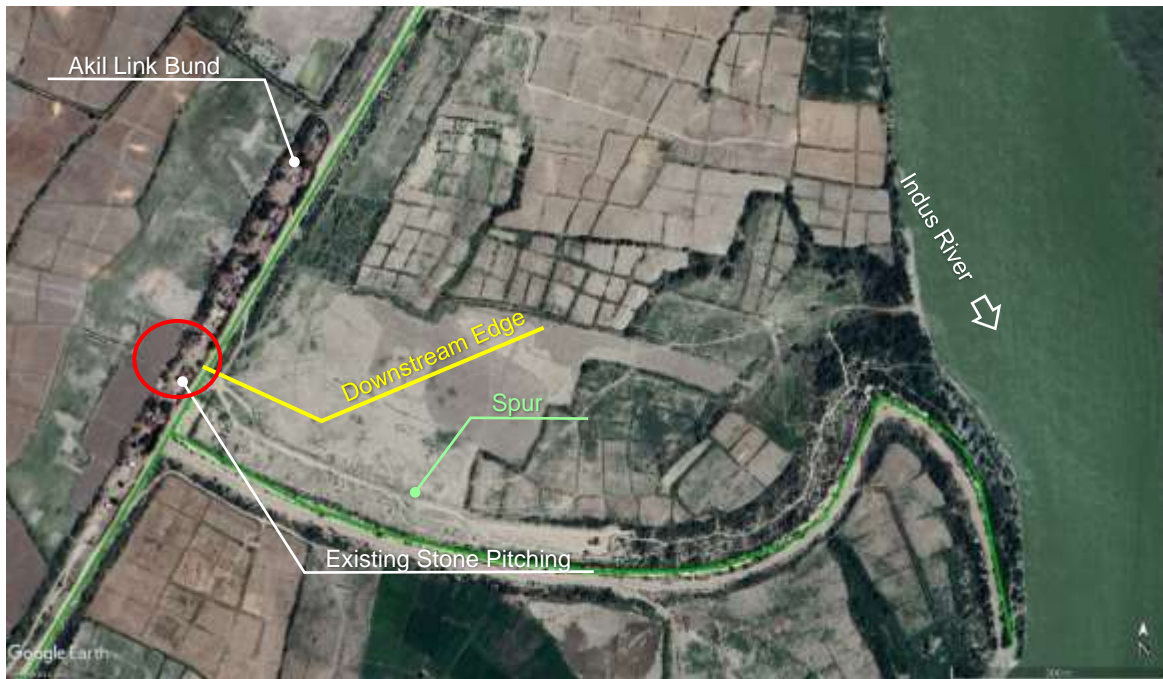
図 3.6.2 浸透対策工下流端付近の河岸侵食状況
