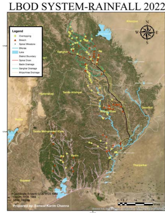
図 2.4.9 2022 年洪水において LBOD 地域の排水路網に発生した被害
