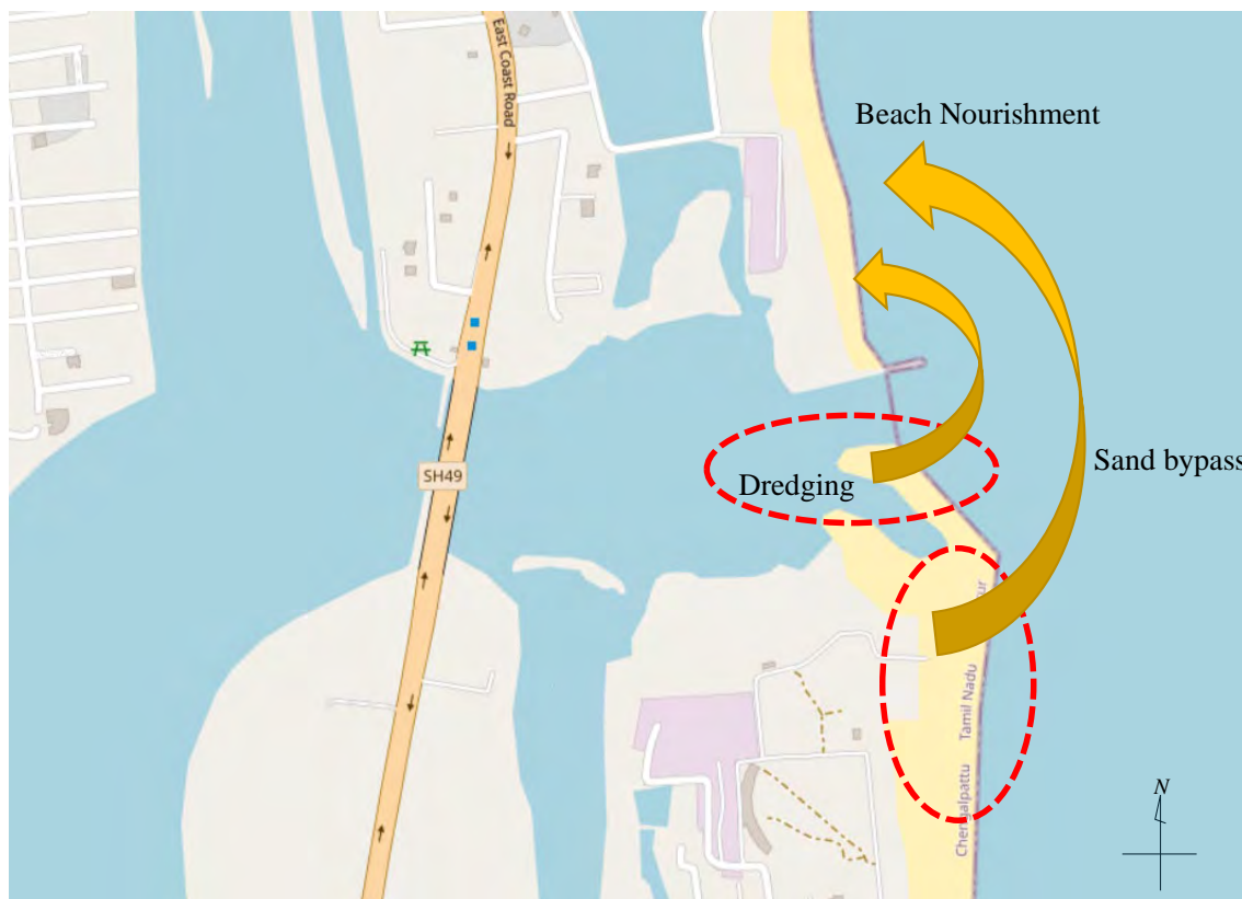
Figure 5-87: 維持浚渫土砂および南側堆積土砂のサンドバイパスによる北側海浜の養浜
