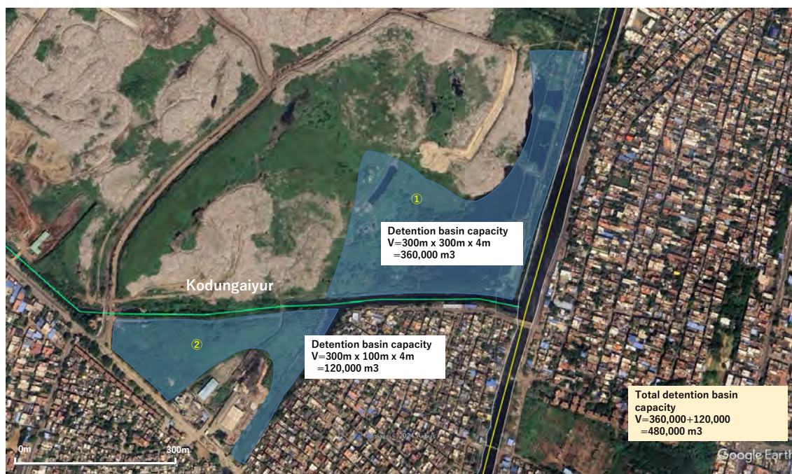
Figure 3-37: Kodungaiyur 遊水地の位置図 (容量 48 万 m 3 )
