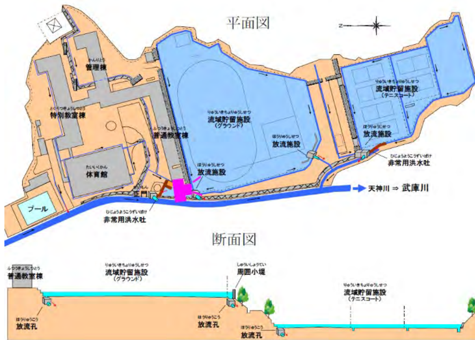
Figure 4-48: 高等学校のグラウンドを使った校庭貯留の例
