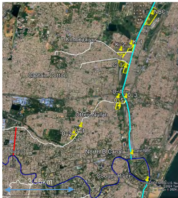
Figure 4-44: North Buckingham 運河に計画されている雨水貯留施設
