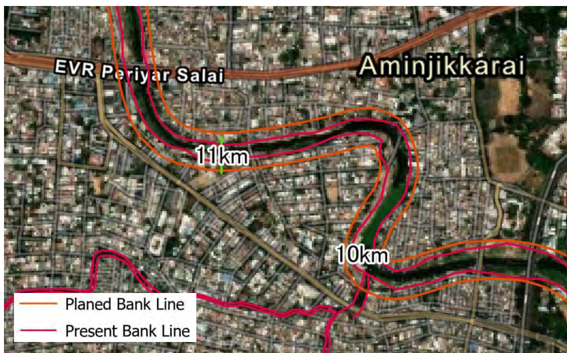
Figure 2-94: 河道拡幅ラインイメージ (Cooum 川)
