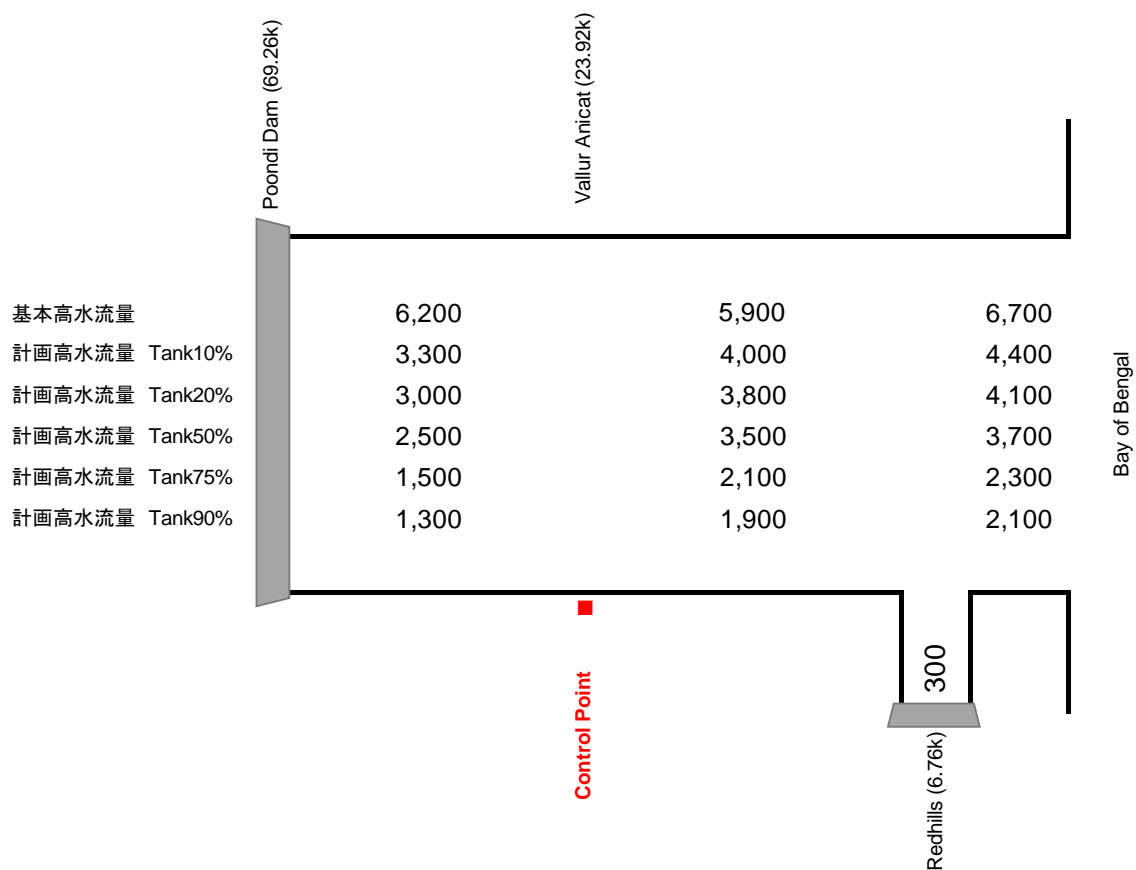
Figure 2-38: Kosasthalaiyar 川流出計算結果 (既設 Tank 改修量との関係)
