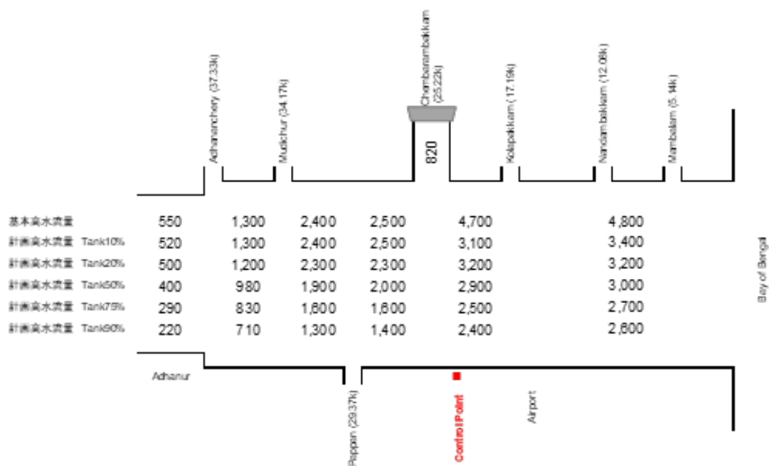
Figure 2-36: Adyar 川流出計算結果 (既設 Tank 改修量との関係)
