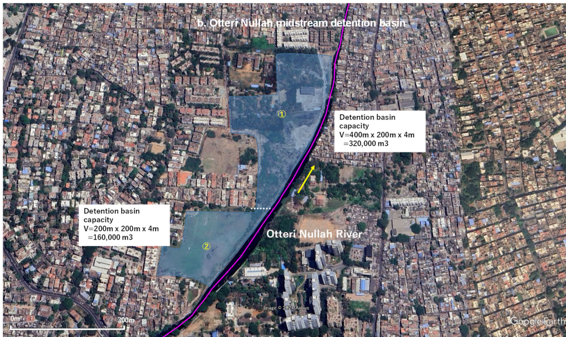
Figure 3-10: Otteri Nulla 上流部における遊水地 (容量 48 万 m 3 )
