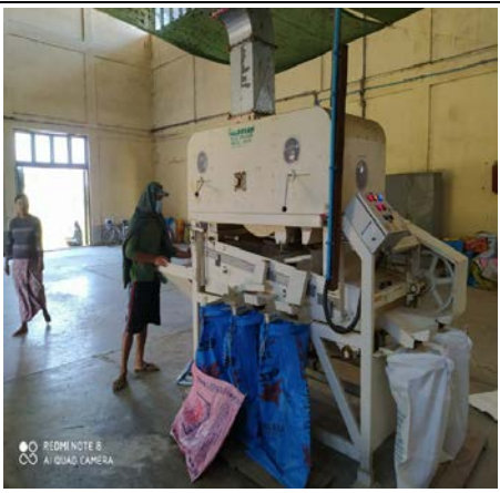
ပုံ (၂) ပေါင်းတည်မျိုးသန့်ခြံ (မေလ ၆ရက် ၂၀၂၁) လုပ်ငန်း- [C.S]မျိုးစေ့အား AGRO-SAWစက်နှင့် စနစ်တကျ သန့်စင်ခြင်း တက်ရောက်သူ - ပေါင်းတည်မျိုးသန့် ခြံမန်နေဂျာ၊ စက်မောင်းသူ နှင့် တောင်သူများ
