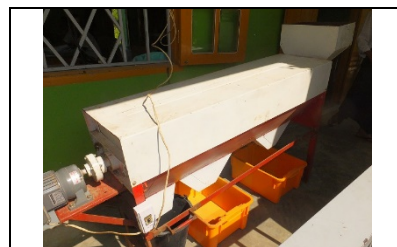
Pyay 市内で試作したケツルアズキ大き選別機。ギアモーターを使用。
