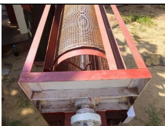
機械内部の写真。金網は任意のサイズに交換できる。金網は Pyay で購入可能。
