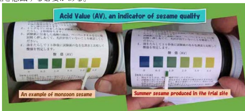
図 2.3.13 品種比較試験圃で生産されたモンスーンゴマの酸価が 3 前後 (左) と夏ゴマの酸価が 1 未満のサンプル例 (右)
