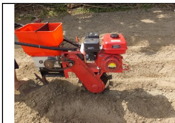
機械本体。小型エンジンによる駆動。播種機としても使用可能。
