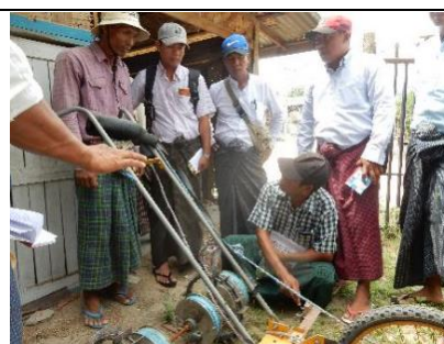
写真 3：播種機② 燃料缶にタイヤをつけた播種機。
