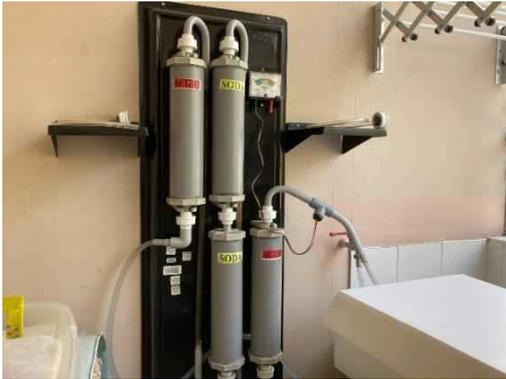
写真-11:研究室に設置されている純水製造装置(日常的に使用され、状態は良い。調湿室素発生装置に必要。)
