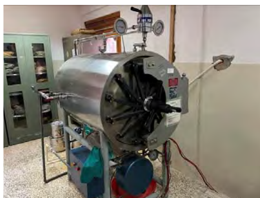
写真 8 : タシガン県病院/高圧蒸気滅菌器
