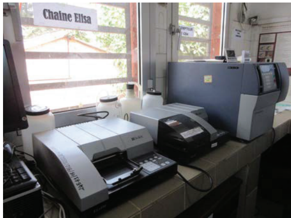
既存 INSP 免疫学ユニット IDDS/FHI が支援している ELISA 装置： 老朽化した機材の間の狭いスペースで使用。老朽化 機材の廃棄・整理と適切な検査室スペースが必要。 (2020年1月21日撮影)
