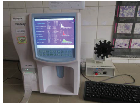
既存 INSP 血液学ユニット 血球計数装置 (3 分類)： INSP の検査では、5 分類測定が必要。 (2020年1月21日撮影)
