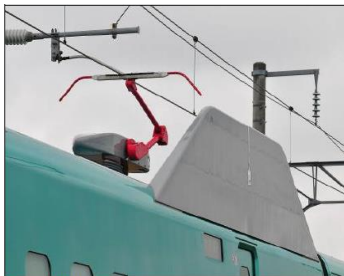
図 4.50 : E5 系のパンタグラフと整風板
