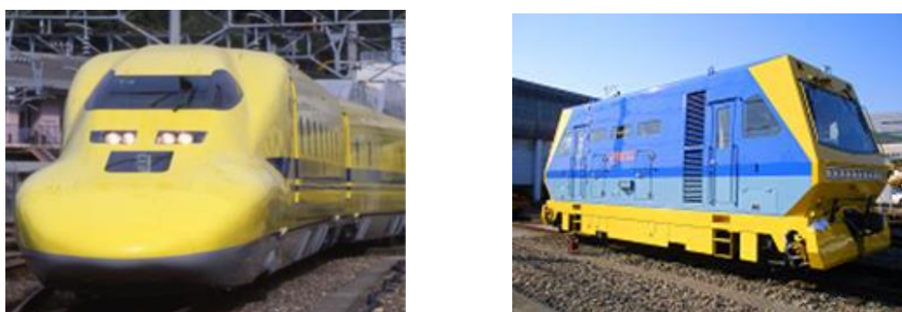
図 S-17：電気軌道検測車 9 と確認車 10
