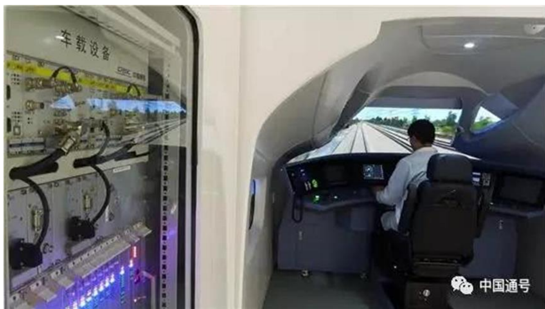
図 3.2.3 高速列車自動運転及び制御システム (CTCS3+ATO) のテスト運行
