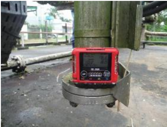
ストレーナ液面計フランジよりガス漏れ
