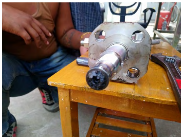
図 4-10 損傷した燃料ノズル
