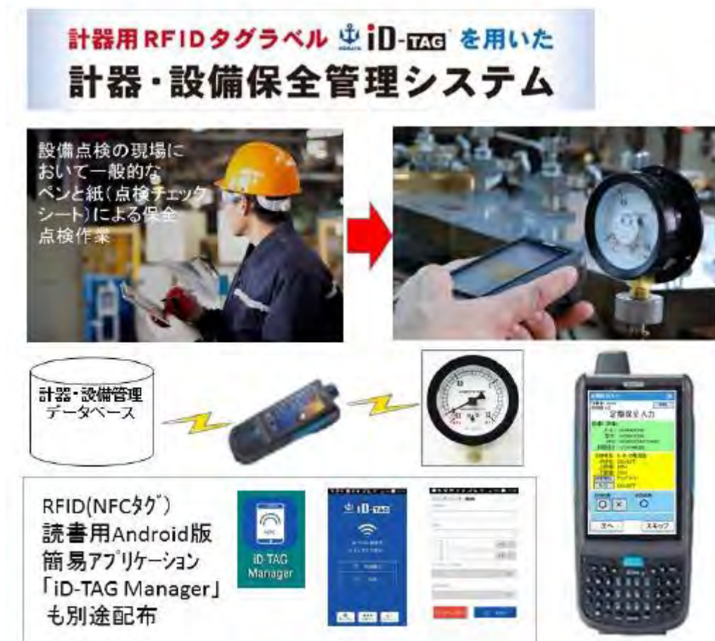
図 6-9 設備保全管理システムの構成例
