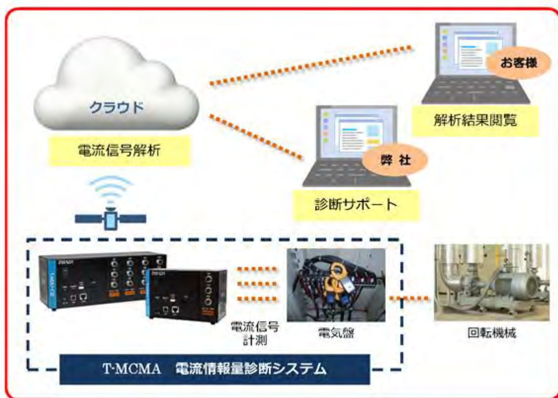
図 6-6 モーター電流診断装置の構成図
