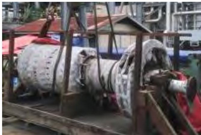
図 5-16 圧縮機の事故後に納められたスペアロータ
