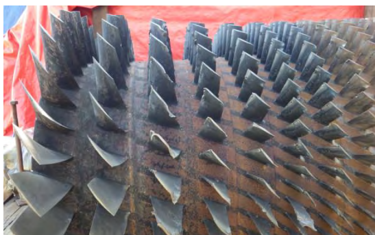
図 3-39 圧縮機翼損傷状況
