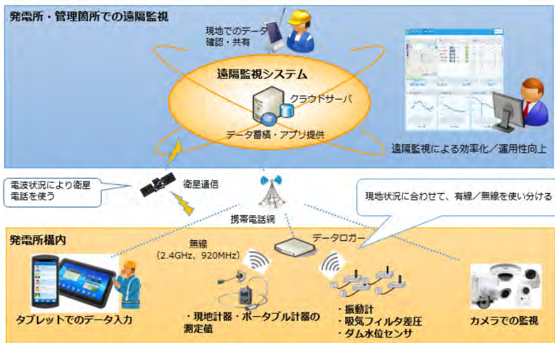
図 6-10 リアルタイム現地データ採取システム構成案 出典:JICA 調査団
