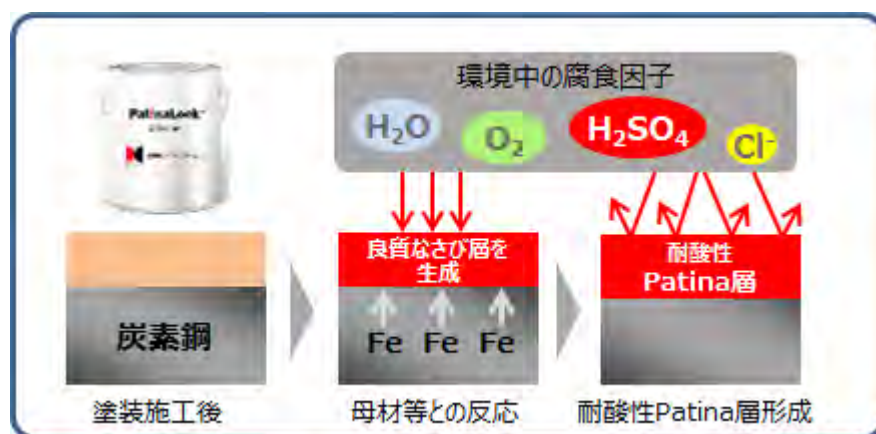
図 6-11 Pat!naLock®-Σ による耐酸性防食層形成メカニズム
