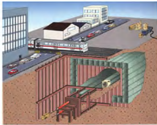
図 4.5.10 エレメント推進けん引工法の概念図
