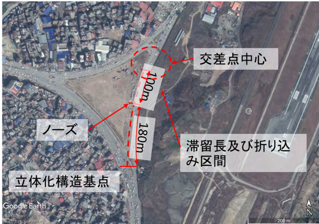
図 4.4.5 案 2 を適用した際の Tinkune 交差点の平面図
