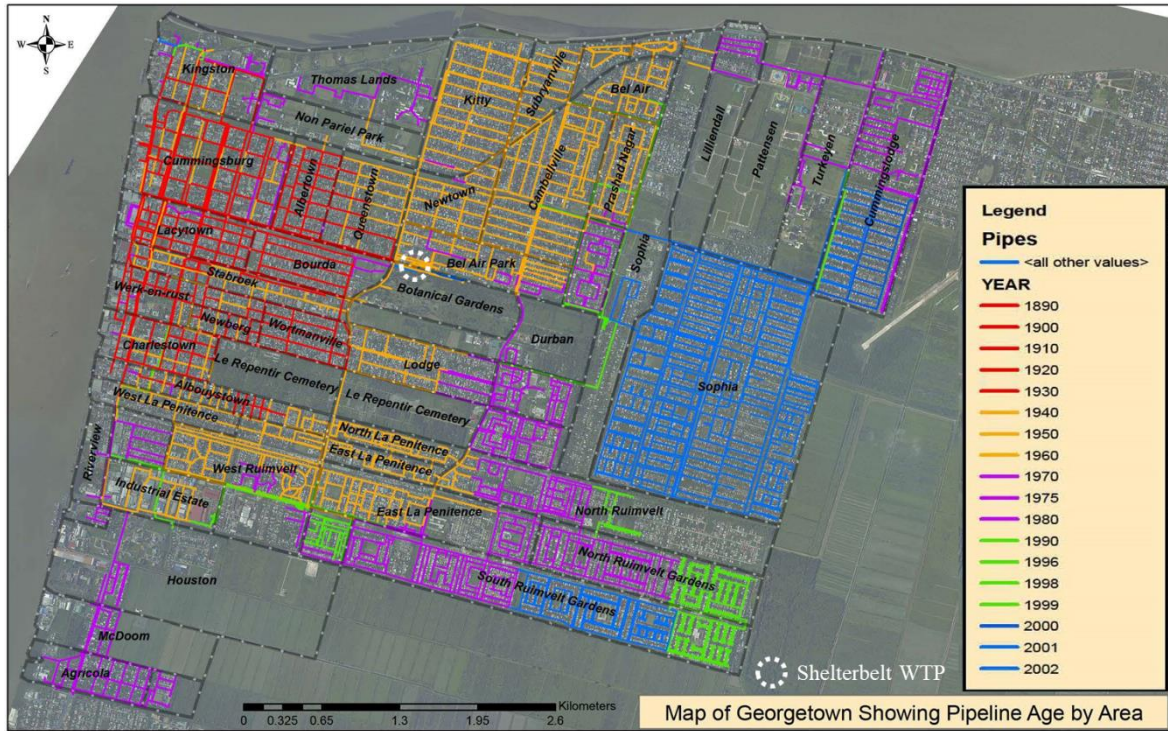
図 7.2.1 Georgetown の配管図（埋設時期別）
