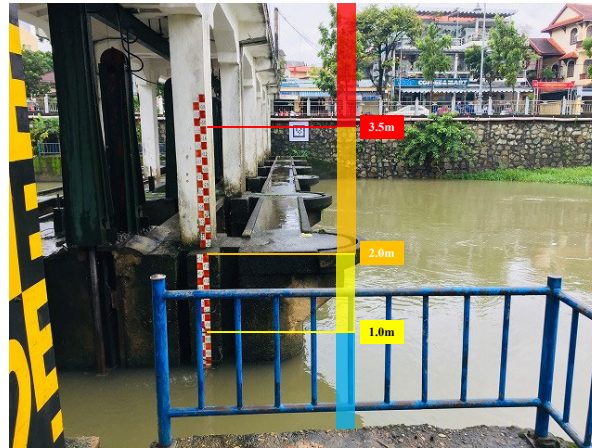
写真 11 実証実験における対象観測所での水位設定の状況（フエ省）
