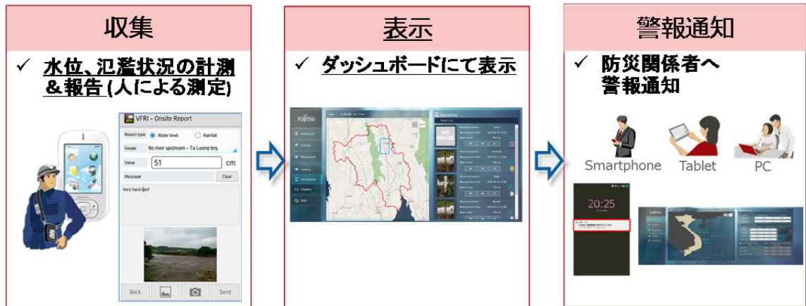
図 4.1.2 実証実験の対象とするシステムの構成概要
