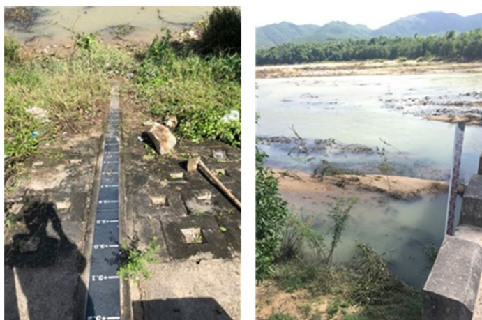
写真 10 ビンディン省の観測場所（左：Nhon Binh 既設量水盤、右：Canh Vinh 既設量水盤）
