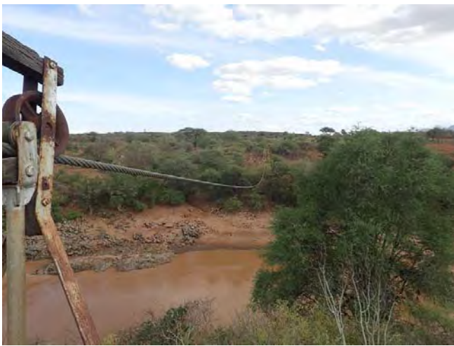
流量観測用の横断ケーブル (4F13、2017/06/14) (長期間使われていない)
