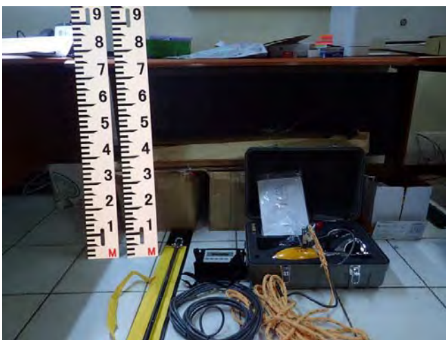
水位標及びプロペラ式流速計 (ロッド付) 一式 (JICA 専門家チーム執務室、2018/02/26)
