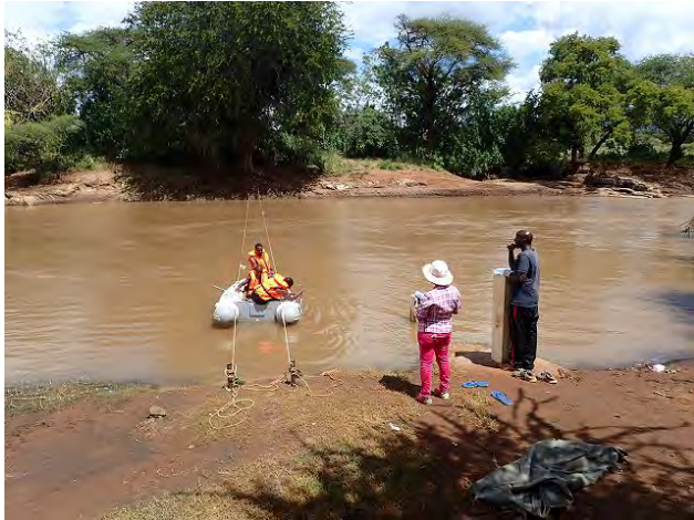
流速計による流量観測 (4F10 : カジータ、2019/06/12)
