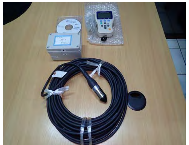
水位計 (センサー)、データロガー及びデータ回収機 (JICA 専門家チーム執務室、2018/02/26)
