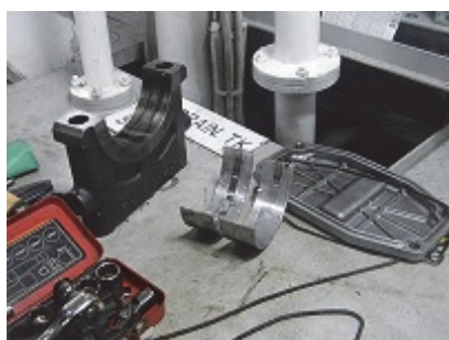
故障中の4番ピストン受け (Micronesian Navigators)
