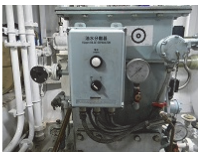
不調の油水分離機 (Micronesian Navigators)
