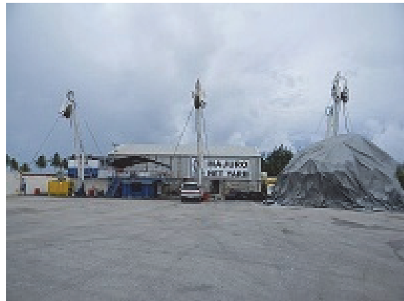
漁網修理設備 (本船と写真のギア間で漁網を展開し、修理する)
