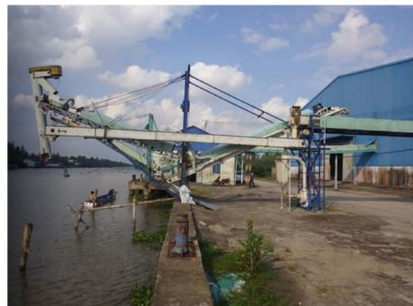
バージから籾を精米工場・倉庫へ搬入するベルトコンベア。搬出時にも使用される。
