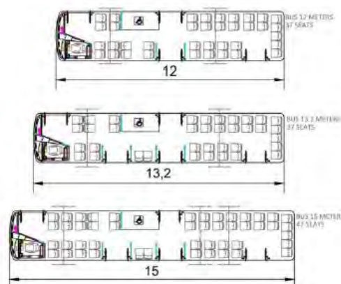
図 5.2.5: 提案されている BRT の車両寸法
