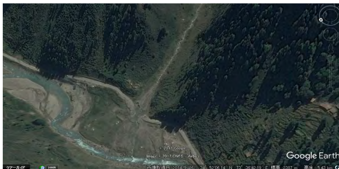
図 4.18 Google Earth による地形判読から得られた候補となる斜面の例(土石流)
