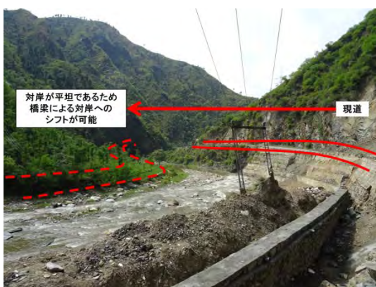
図 4.68 対岸部分で同等の道路建設が可能(橋梁等による迂回路建設が可能)な箇所の例(N35_3) (出典:調査団)
