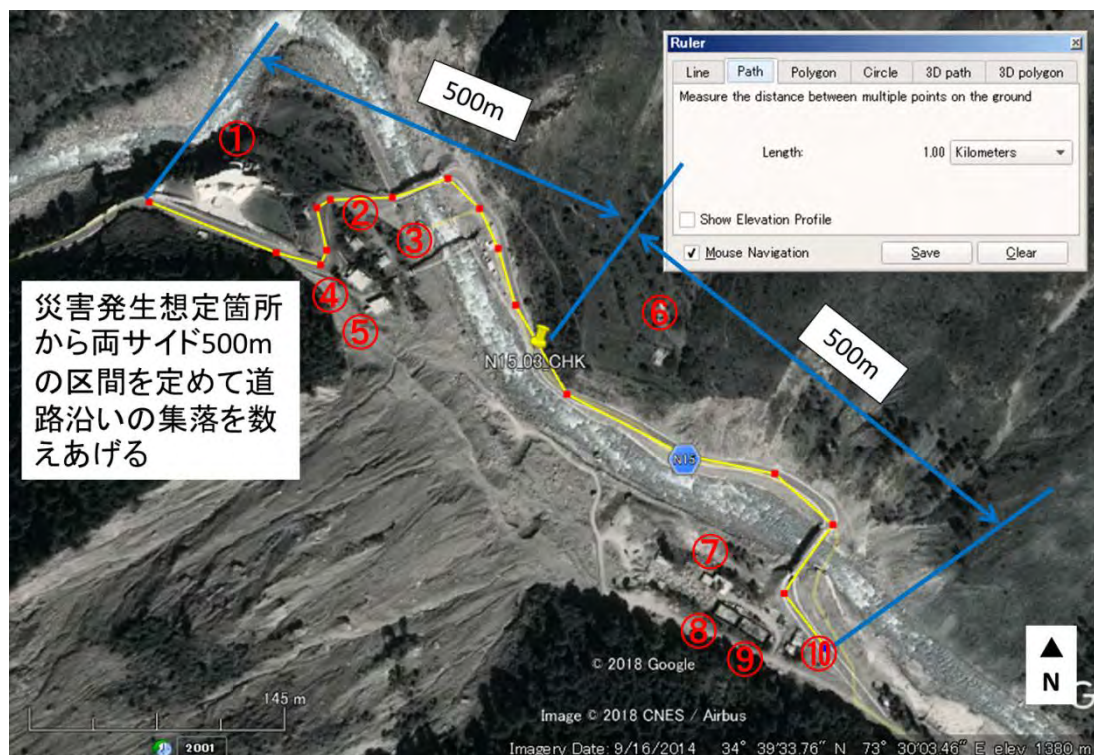
図 4.65 N15_3 を例とした世帯数の数えあげ方法の模式図
