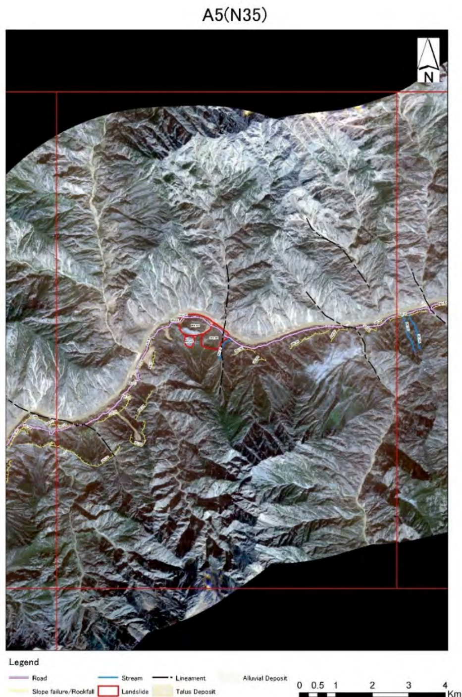
図 4.23 衛星写真の判読により抽出された候補となる斜面の例
