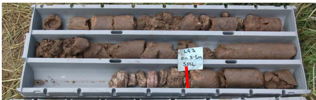
写真 5.1-14 (BH-3)ボーリングコア（細砂とシルト質砂、GL-8.5m から割目沿いに風化した片麻岩）(BH-3) Boring Core (Soil: Fine Sand and Silty Sand & Weathered Rock: Gneiss)
