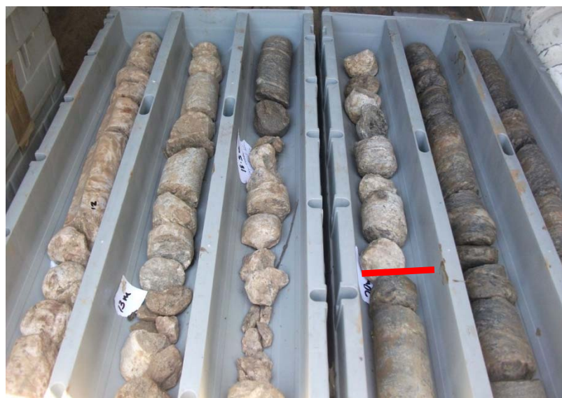
写真 5.1-15 (BH-3)ボーリングコア（片麻岩、GL-20.0m まで亀裂の多い硬岩、GL-20.0m から硬岩）(BH-3) Boring Core (Weathered to Slightly Weathered Rock: Gneiss)
