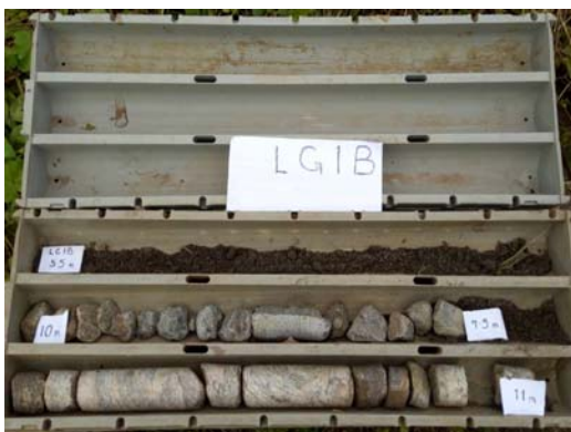
写真 5.1-12 BH-1'（右岸側）のコア状況
