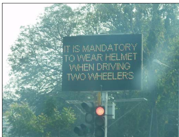
図 2.1.27 可変情報板及び表示メッセージ
