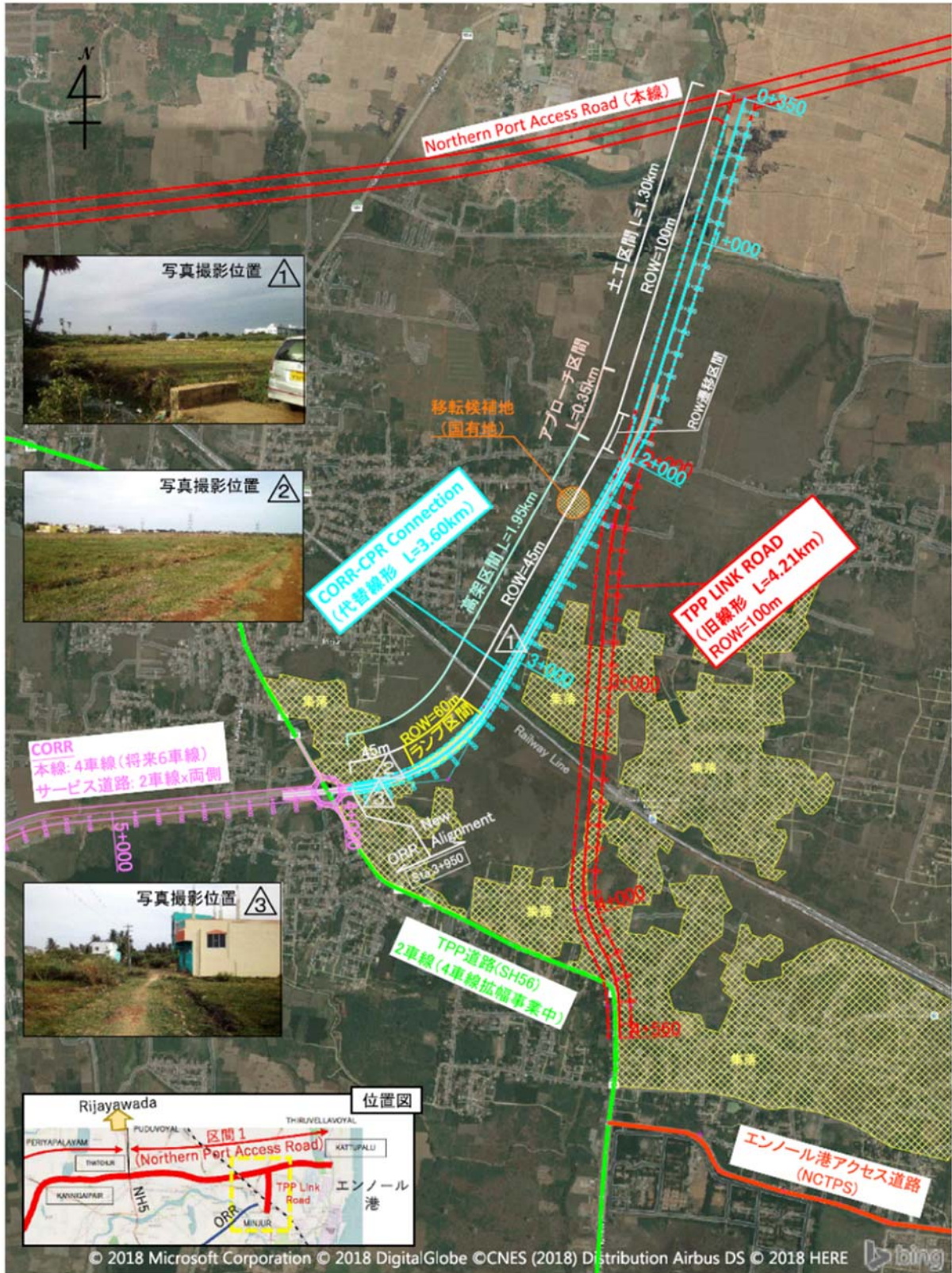
図 6.5.9 TPP Link Road の線形変更
