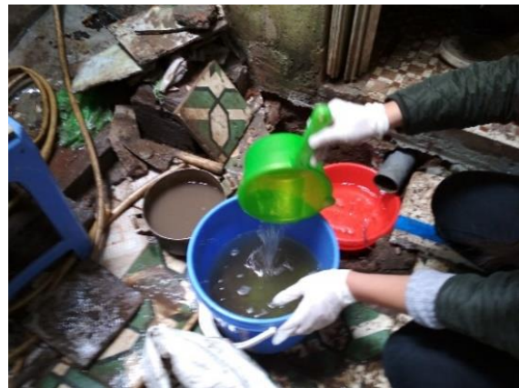
Ảnh 2-9 Lấy mẫu nước thải từ bể tự hoại (HN2TR1)
