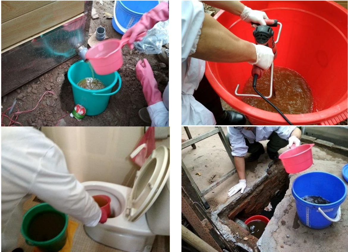
Ảnh 2-11 Lấy mẫu nước thải từ toilet tạm và bể tự hoại (HN1HM1)
