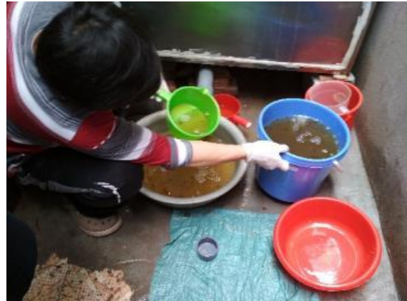
Ảnh 2-7 Lấy mẫu nước thải từ toilet tạm (HN2TR1)
