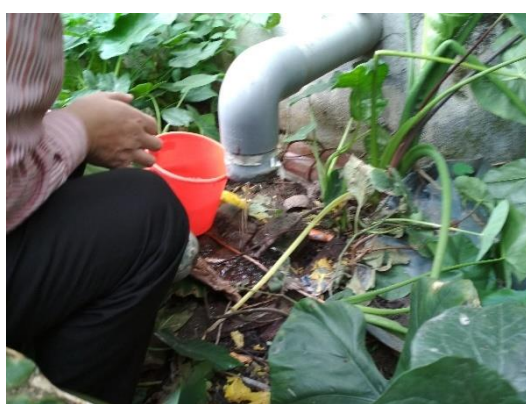
Ảnh 2-4 Lấy mẫu nước thải đầu ra từ bể tự hoại tại Hải Phòng (Nhà riêng, ngày 20/01/2018, nước thải đã xử lý chảy vào đất ngập nước)
