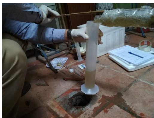
Ảnh 2-3 Lấy mẫu nước thải đầu ra từ bể tự hoại tại Hà Nội (nhà riêng, ngày 16/01/2018)
