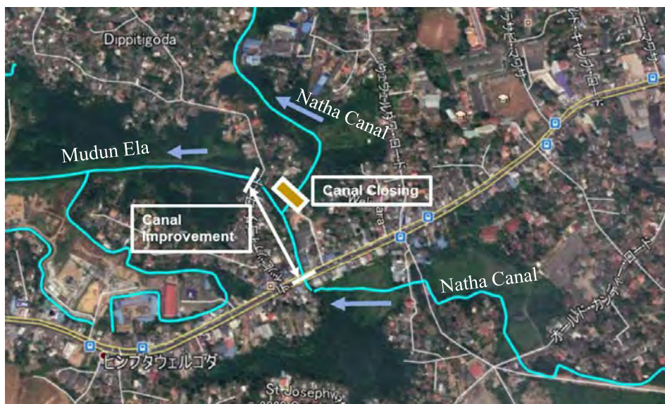
図 6.6.2 Mudun Ela Diversion の改修概要
