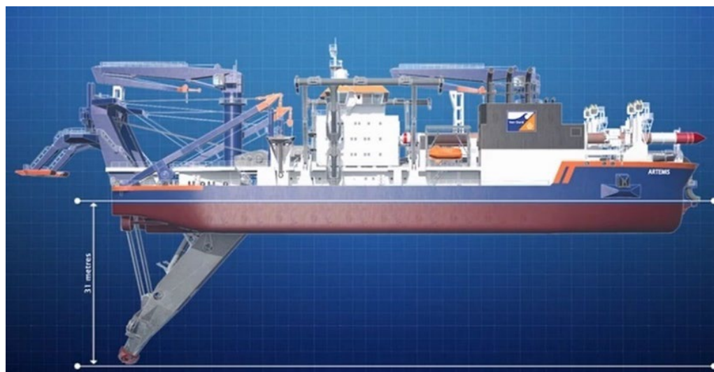
図 5.8.12 ポンプ浚渫船の例
