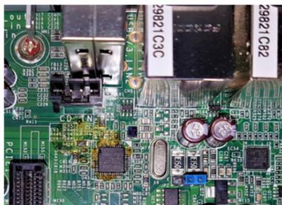
ネズミの糞尿による PCB 基盤破損
