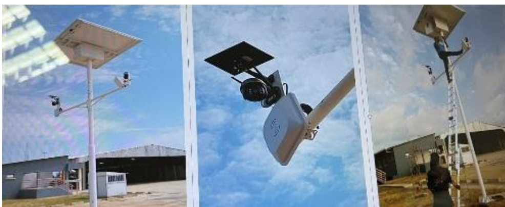
Figure 7-3 Antennes RFID servant à la surveillance des camions de marchandises
