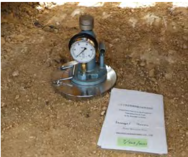
直径 30 cm の円盤とジャッキをセット
