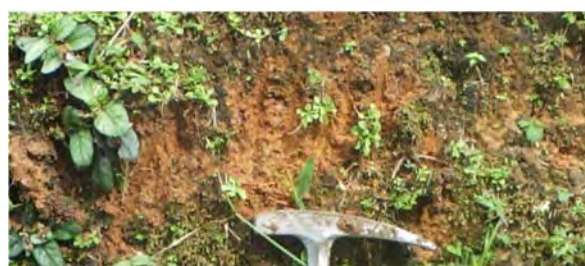
図 1.2.4 コクサイ変電所基礎の盛土 (風化した火山岩土壌が盛土材)
