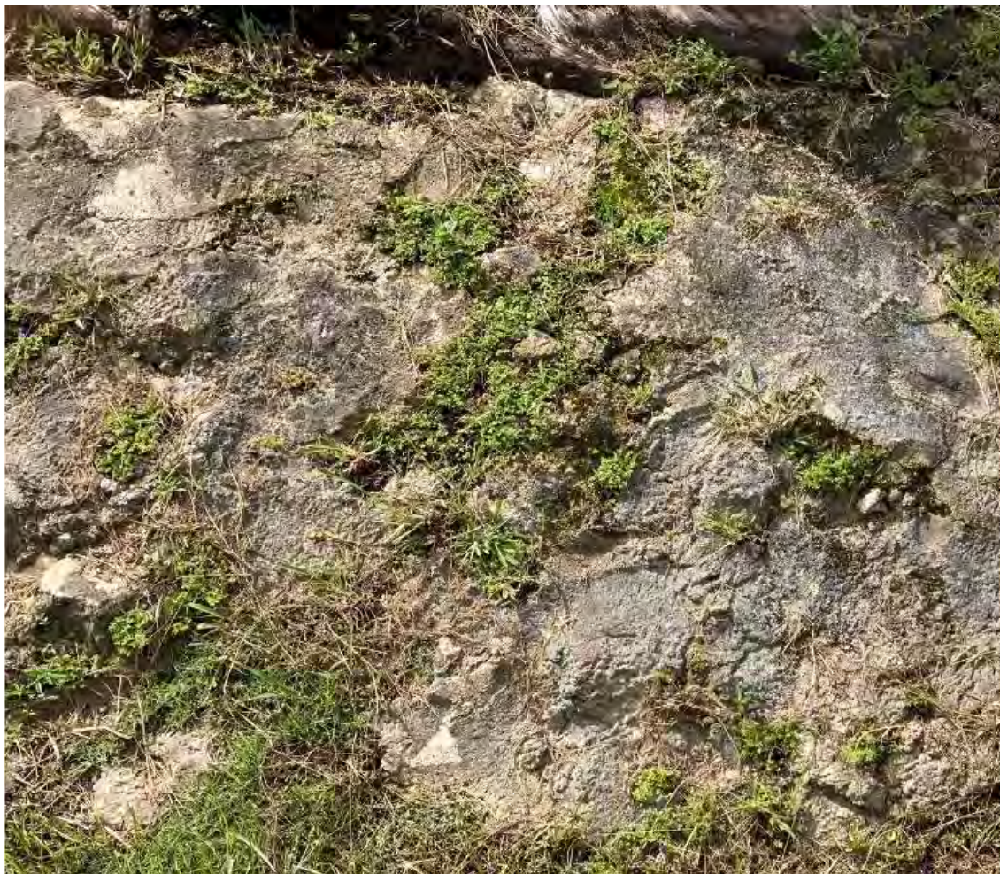
図 1.1.4 東屋基礎部の玄武岩質安山岩（自破碎状溶岩溶岩）
