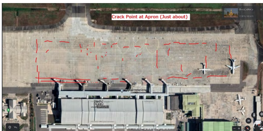
図 4.22 国際線エプロンのひび割れ位置
