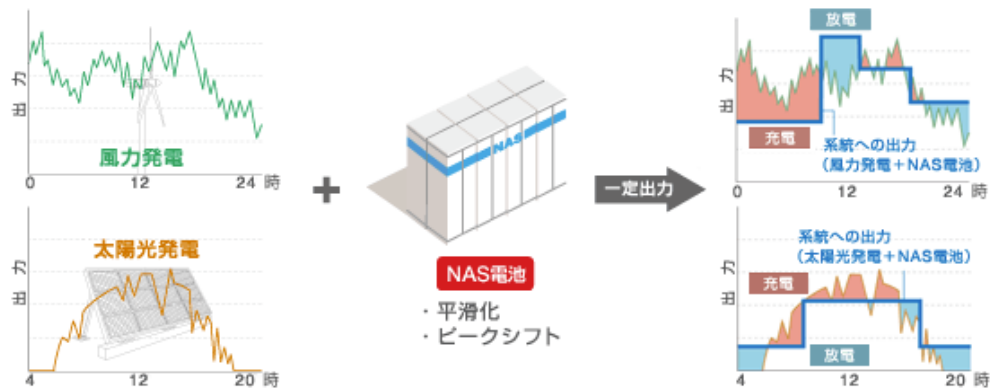
図 5-22 NAS 電池を活用した再エネの安定化
