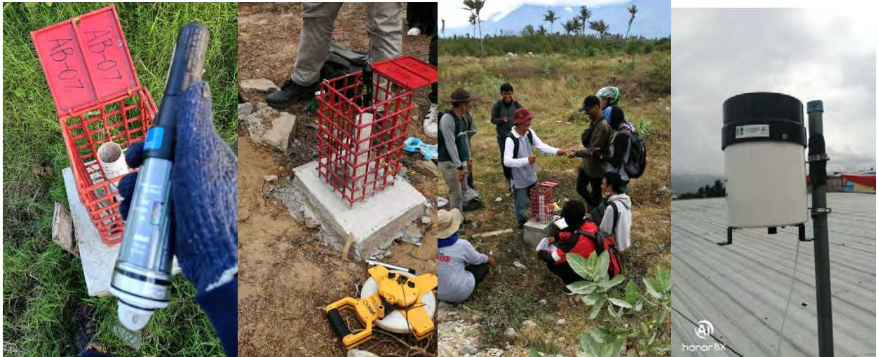
図 7-9 観測孔と HOBOTOPUS 社製ダイバー式の自記水位計及び自記雨量計
