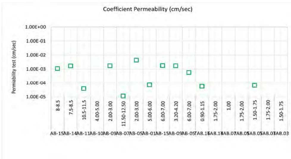
図 4-73 シルト層・砂質シルト層の室内透水試験結果
