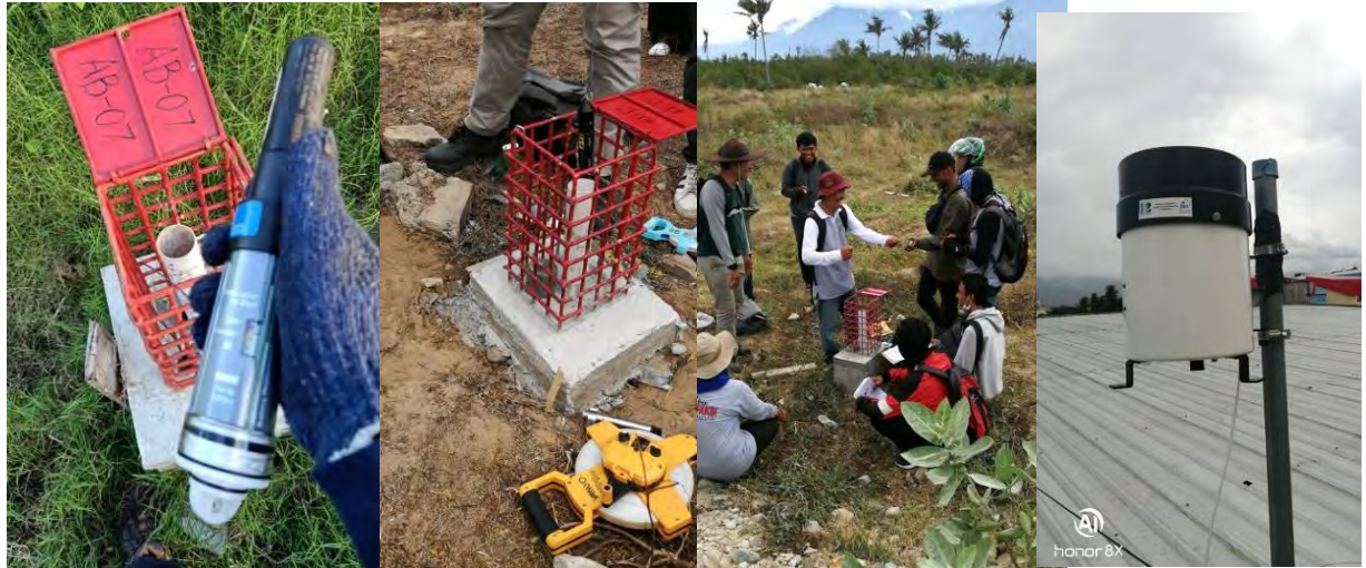
図 3-57 観測孔と HOB0 社製ダイバー式の自記水位計及び自記雨量計
